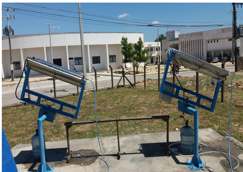
Figura 7: Concentrador com Tubo de Vidro e concentrador com plástico
