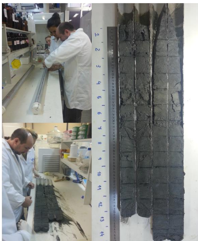
Figura 11 - Abertura do testemunho e divisão em seções.
