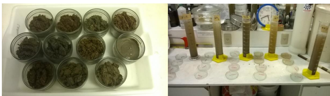
Figura 12 - Análise granulométrica. a. sedimentos para a estufa; b. pipetagem.
