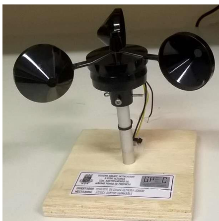
Figura 5.1 – Anemômetro tipo concha, modelo NRG 40C
