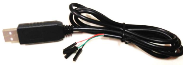
Figura 4.15 – Cabo utilizado para comunicação entre módulos Zigbee e PC.
