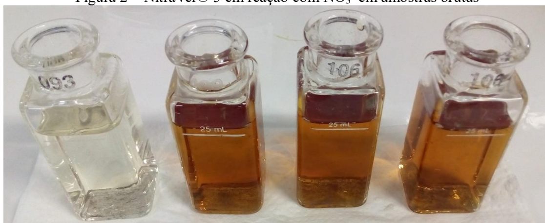
Figura 2 – NitraVer® 5 em reação com \text{NO}_3^- em amostras brutas
