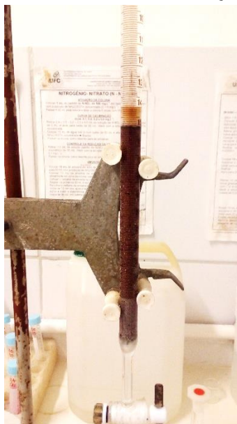
Figura 12 – Coluna Redutora de Cd do LAQA
