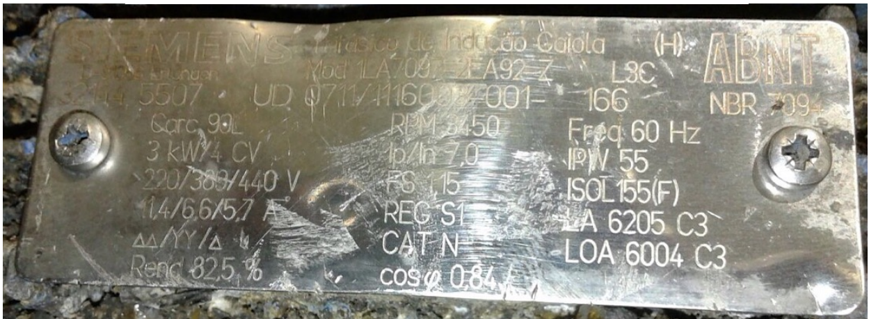
Figura 8: Placa de identificação de um motor SIEMENS
