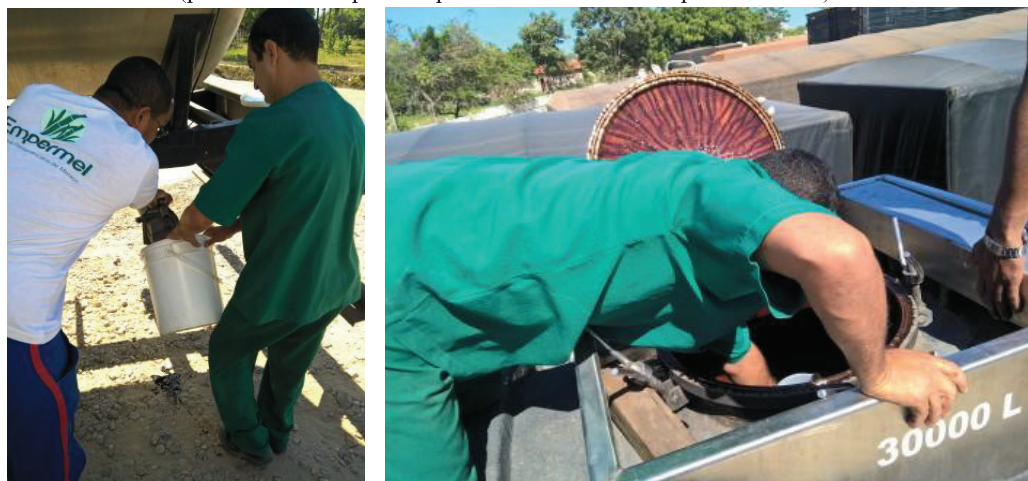
Figuras 5a / 5b - Coleta de amostra líquida a granel para análise laboratorial (parte inferior e parte superior do caminhão respectivamente).
