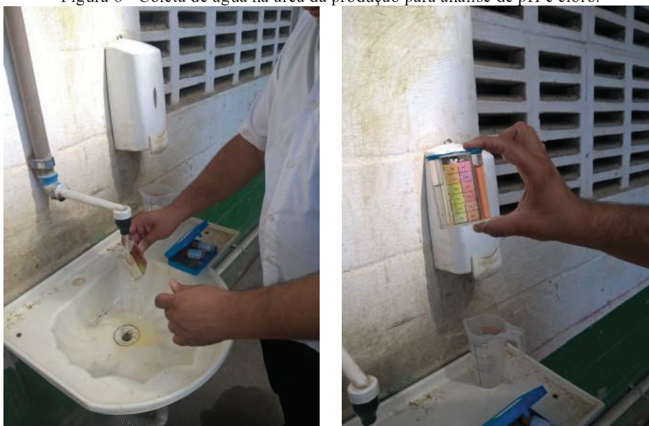
Figura 8 - Coleta de água na área da produção para análise de pH e cloro.
