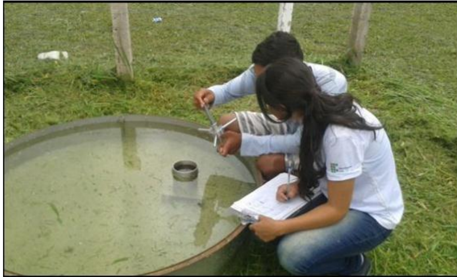
Figura 9 - Medição da evaporação do tanque classe A (ECA), Tianguá – CE, 2016
