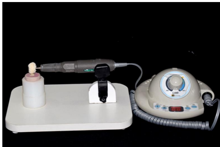
Figura 1: Dispositivo para padronização da posição do motor de polimento. Matriz de silício na de condensação utilizada para encaixo dos espécimes.
