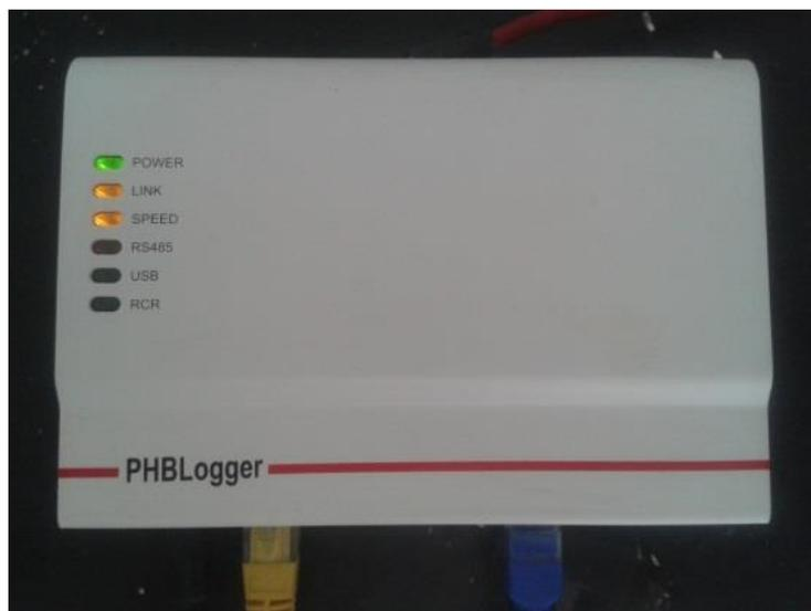
O *Datalogger* tem uma comunicação com o inversor através de uma ligação via RS485. O fluxograma da coleta de dados da geração é mostrado na Figura 18, o sistema permite arquivar as informações coletadas a cada 10 minutos e transmite
