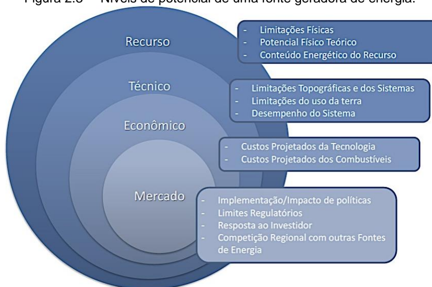
Figura 2.3 – Níveis de potencial de uma fonte geradora de energia.
