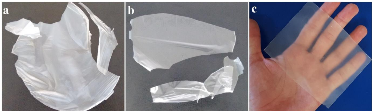
Figura 22 – Fotografias: (a) Filme de CBNF-HS não plastificado, (b) Filme de CBNF-HS e HA não plastificado, (c) Filme de CBNF-HS e HA plastificado com sorbitol (HS 40 HA 40 S 20 )
