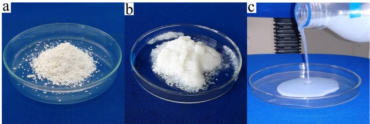
Figura 8 - Fotografias: (a) CB seca triturada, (b) CB oxidada, (c) Suspensão de CB de meio sintético nanofibrilada (CBNF-HS)
