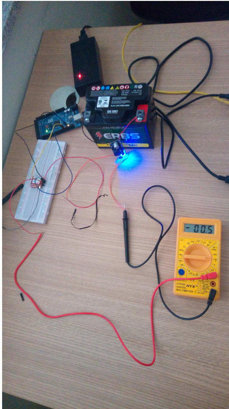
Figura 12 – Arduino ligado ao SIM800L
