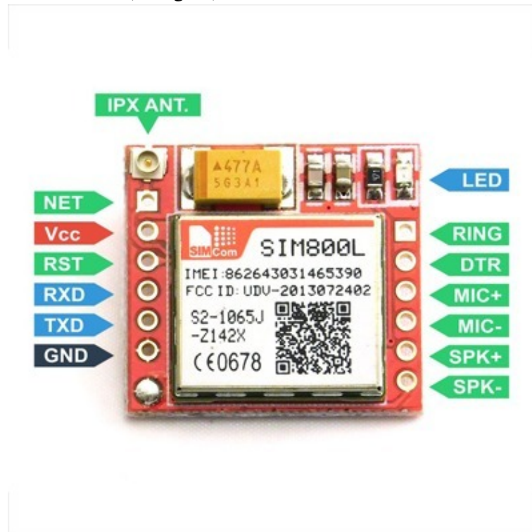
Figura 3 – Módulo SIM800L (Pinagem)
