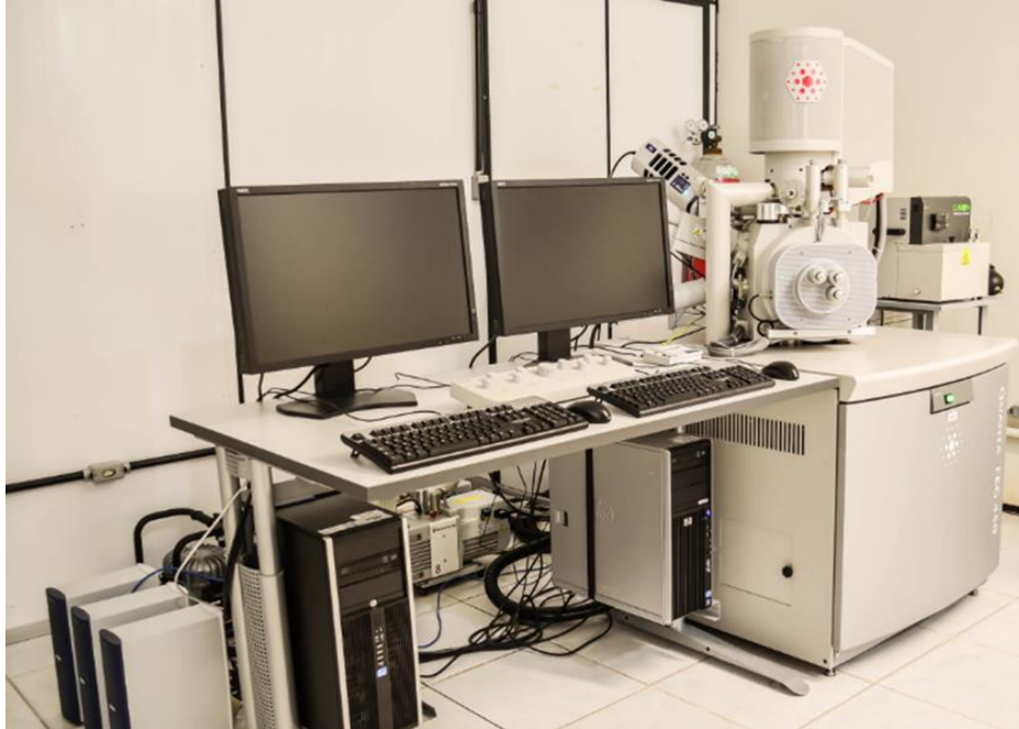
Figura 8 - Microscópio Eletrônico de Varredura Quanta 450 FEG – FEI com detector de raios-x Oxford acoplado.
