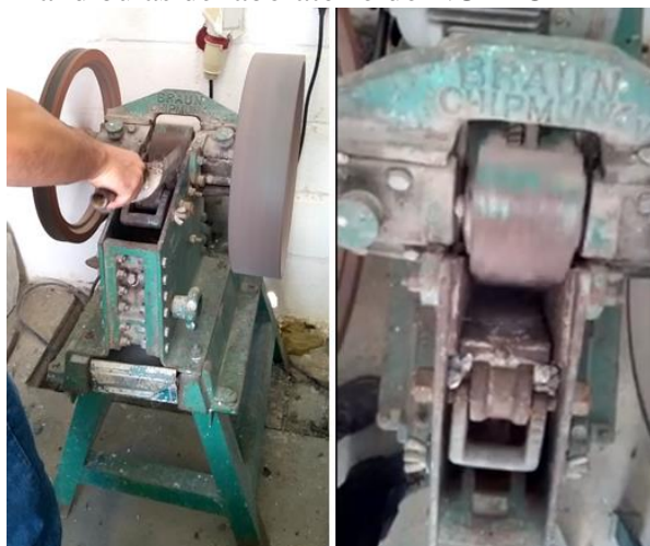
Figura 21 – Britador de mandíbulas de laboratório do NUTEC
