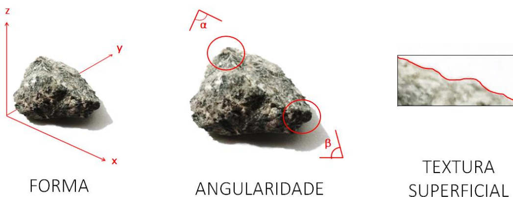
Figura 4 – Forma, angularidade e textura superficial das partículas de agregado
