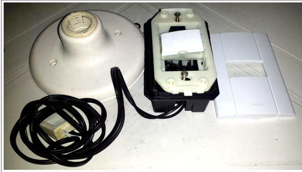
Figura 26 – Protótipo embutido numa caixa de rede elétrica.
