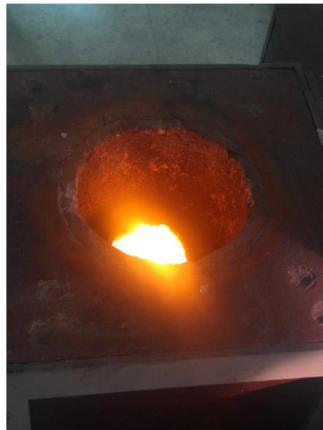
Figura 11 - Processo de fundição do aço no forno de indução
