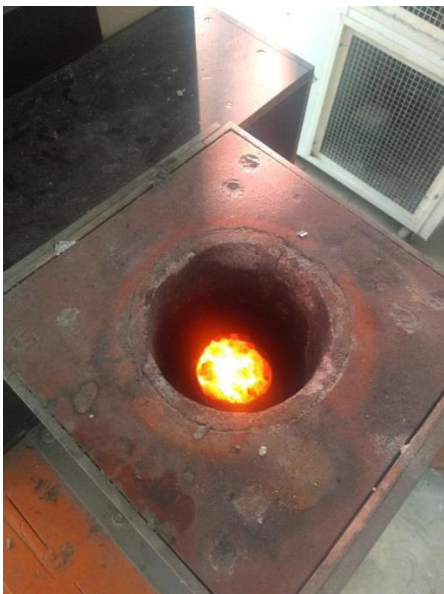
Figura 11 - Processo de fundição do aço no forno de indução
