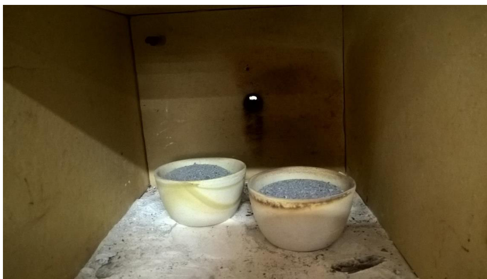
Figura 3 - Borra de alumínio no forno mufla para tratamento de calcinação.
