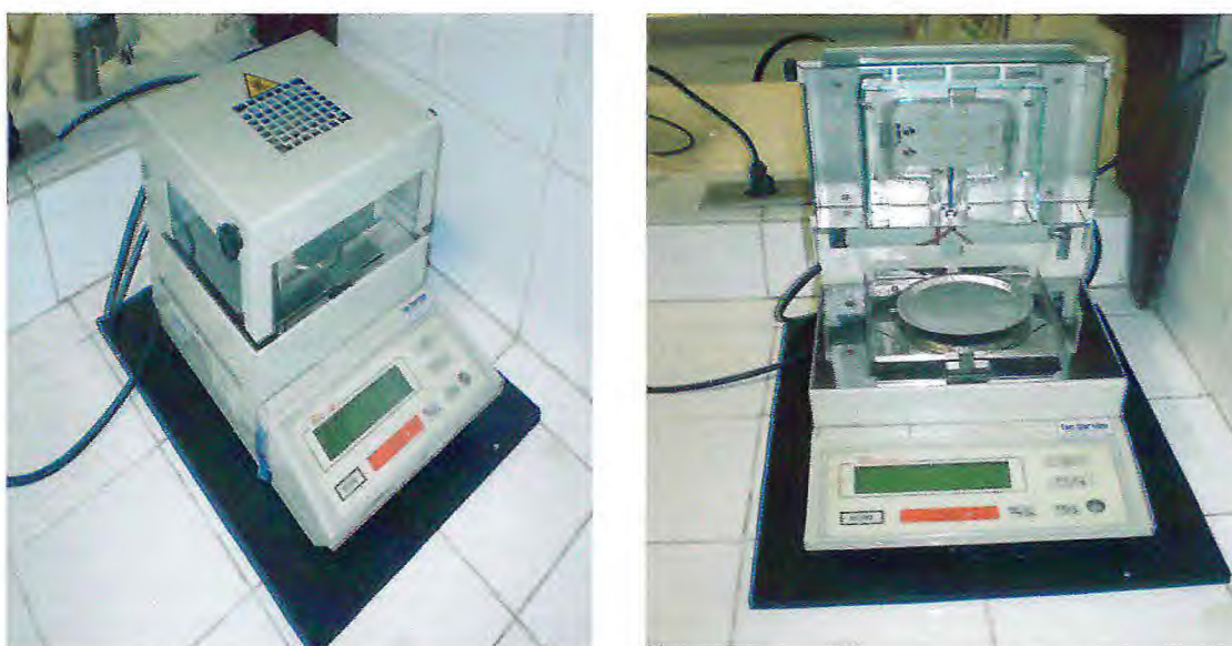
Figura 3 – Equipamento utilizado na determinação de umidade empregando radiação infravermelha (com permissão da Marte Balanças)
