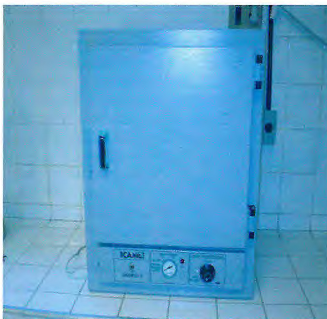
Figura 2 – Equipamento utilizado na determinação de umidade pelo método da estufa como referencia (com permissão da ICAMO)
