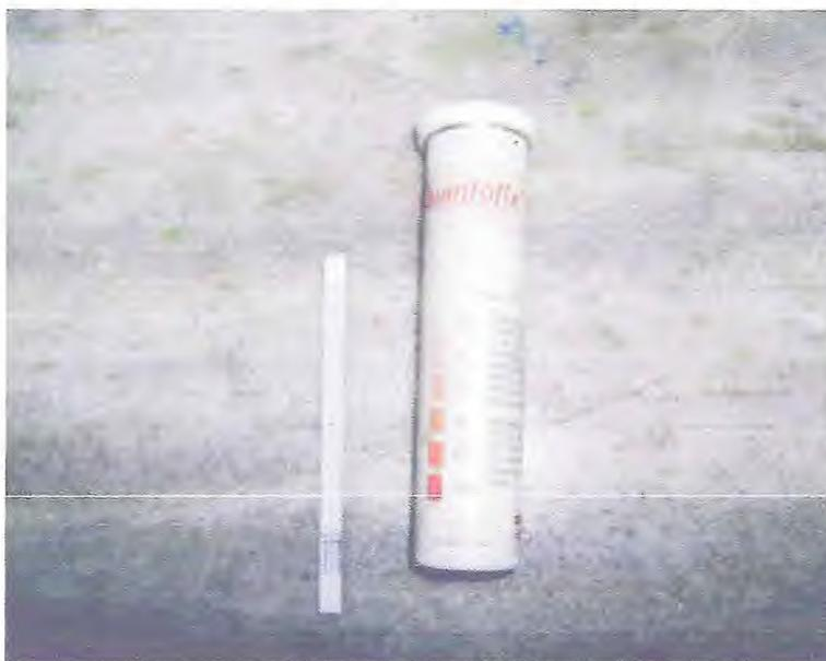
Figura 5 - Embalagem do semiteste quantitativo (fita "MERCK"), para determinação do teor residual de SO<sub>2</sub> nas caudas de lagosta, na recepção da Indústria INTERFRIOS – Intercâmbio de Frios S.A., em Fortaleza, Ceará.
