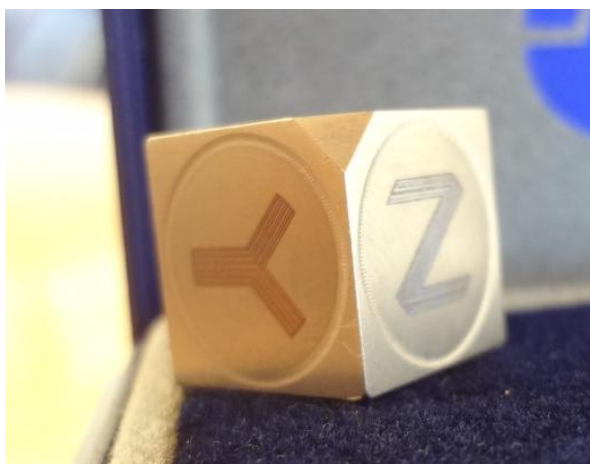
Figura 10 - Acelerômetro triaxial modelo 356A02
