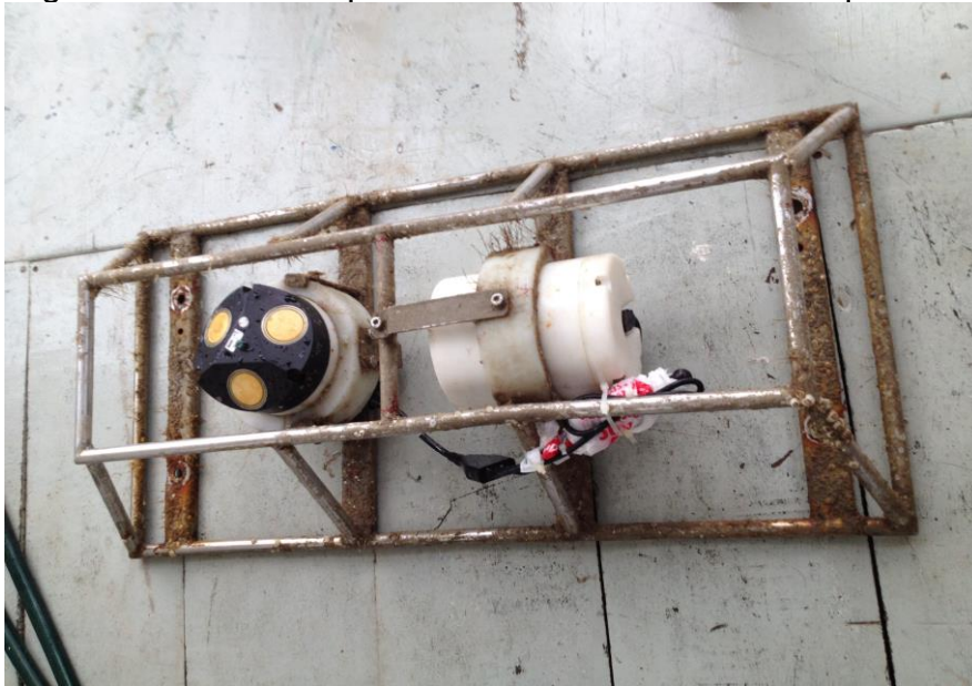
Figura 1 – ADCP acoplado a uma estrutura metálica para fundeio.
