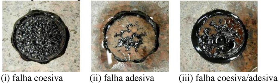
Figura 20 – Tipos de falha em ensaios de arrancamento.
