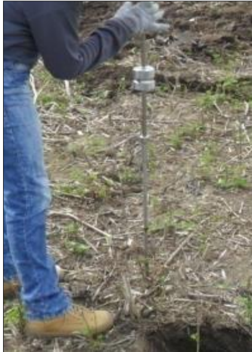
Figura 12 – Penetrômetro de impacto
