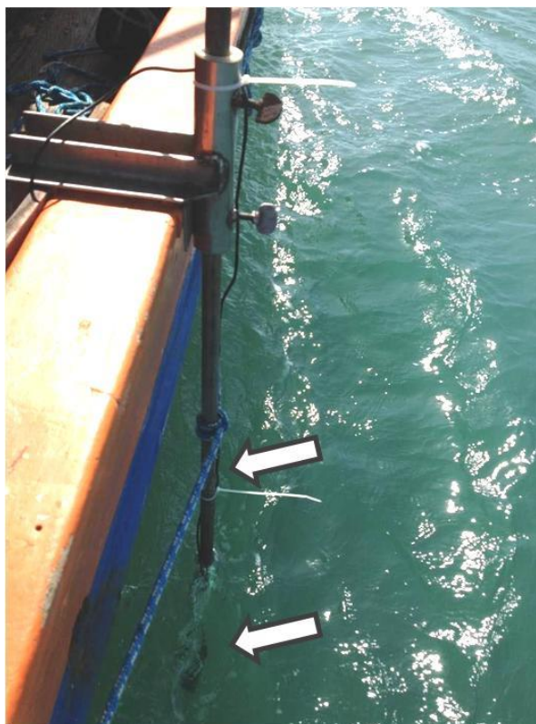
Figura 4 – Transdutor do GPS, posto a boreste da embarcação.
