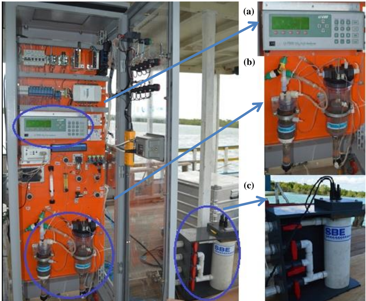
Figura 6. Instrumento de medição do pCO 2 , com destaque (a) no Licor, (b) nos equilibradores e (c) no termosalinômetro SBE 21.
