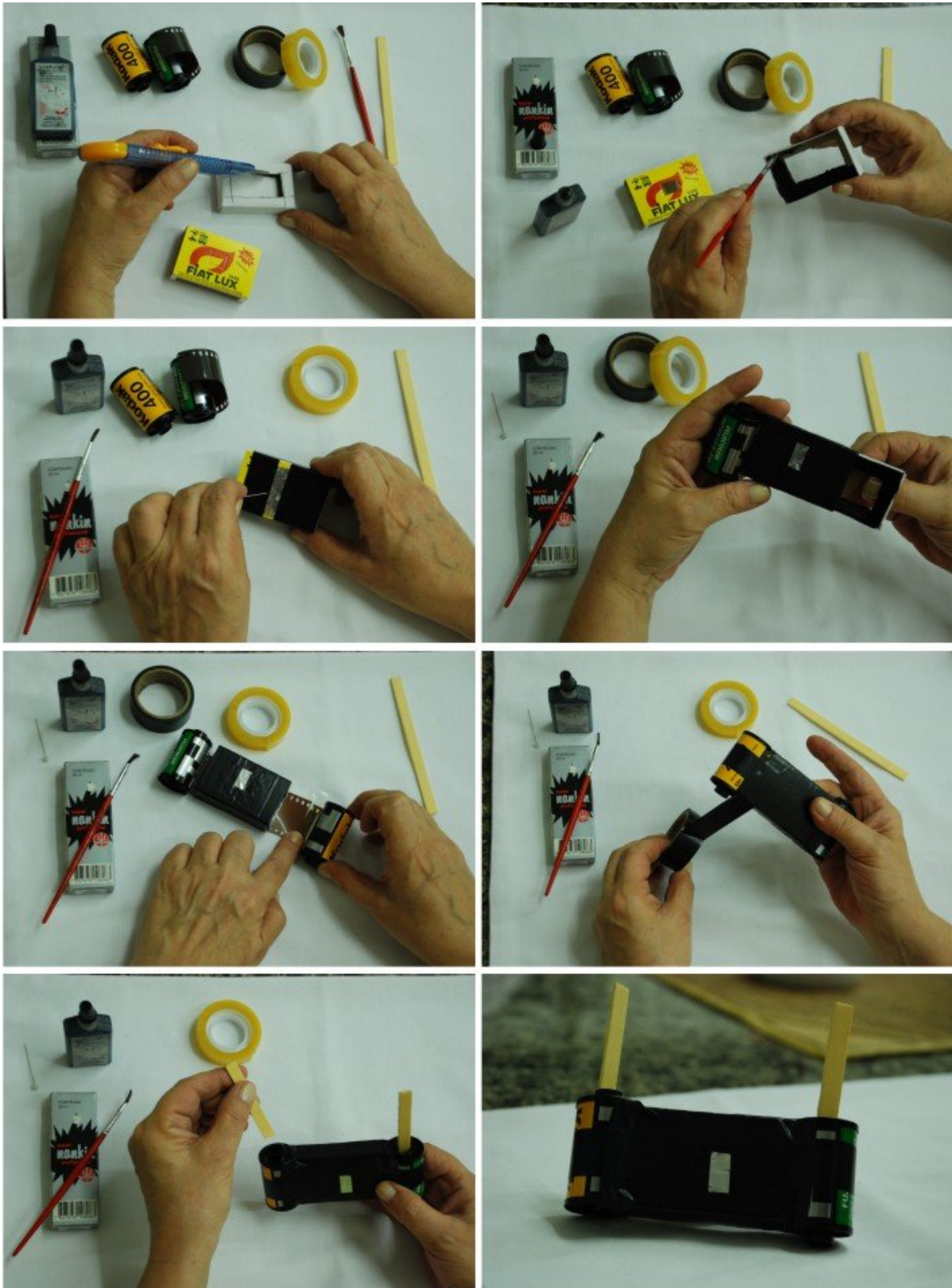
Figura 1: Montagem da máquina de Pinlux.
