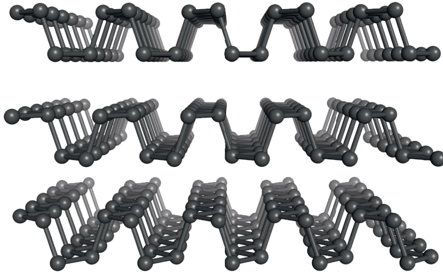
Figure 4: Estrutura cristalina do fósforo negro. É possível observar a estrutura enrugada de cada plano. Um único desses planos de átomos de fósforo constitui o fosforeno. [12]
