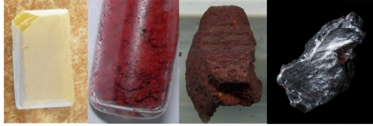
Figure 3: Amostras de alótropos do fósforo. Da esquerda para a direita: Fósforo branco, vermelho, violeta e negro. [10, 11]
