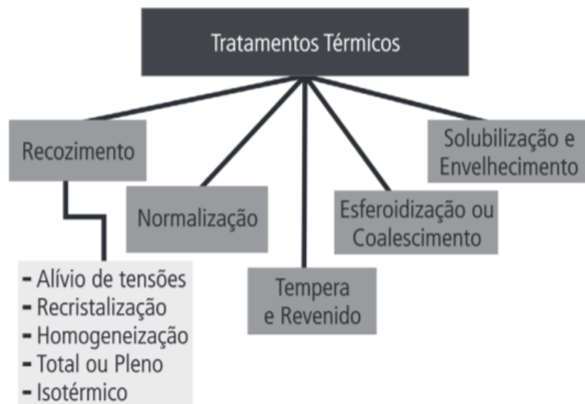
Figura 18 – Tipos de tratamentos térmicos dos aços.
