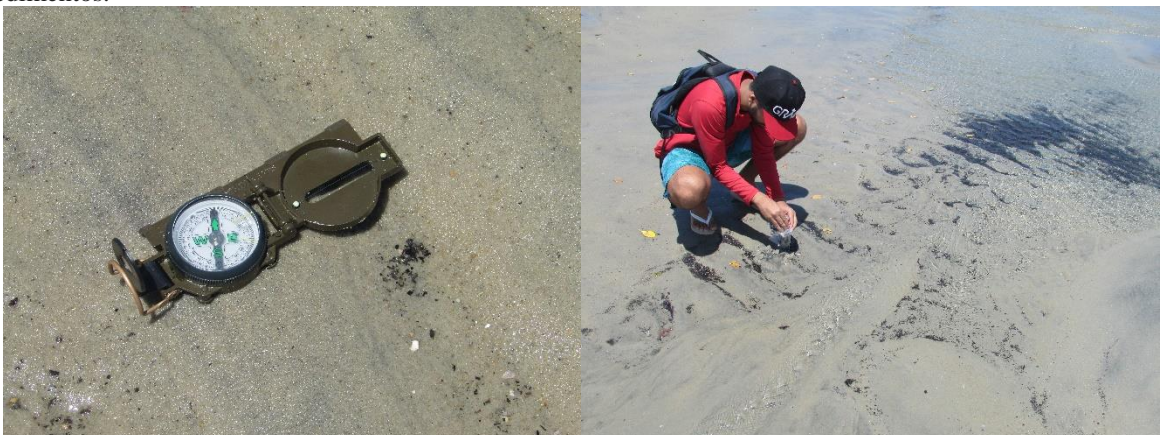
Figura 8. Aferição da direção das feições de fundo com o auxílio de uma bússola e coleta de amostra de sedimentos.
