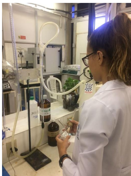
Figura 5 – Sistema de pipetas comunicantes utilizado no método do Calcímetro de Bernard modificado.
