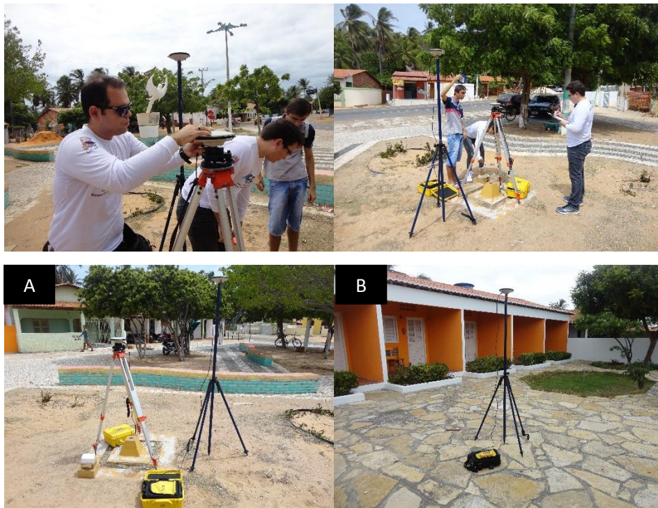
Figura 28 (A e B): Transferência do Referencial de Nível (RN) para as proximidades da área de monitoramento. A) Estação IBGE 2726F – 5,623m; B) RN transferido – 3,847.
