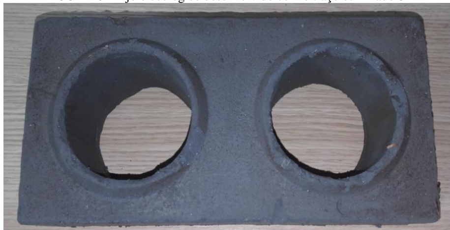
FIGURA 6 - Tijolo ecológico desenvolvido com o traço otimizado 8H
