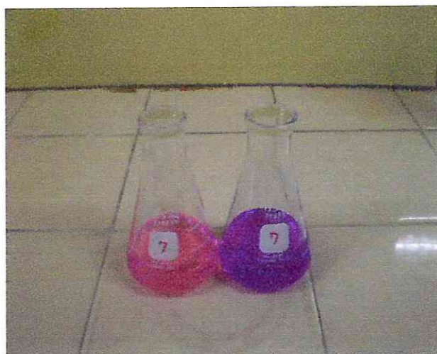
Figura 11 - Determinação da dureza de cálcio. Coloração rosa antes da titulação com EDTA e lilás após a titulação determinando a dureza de cálcio.
