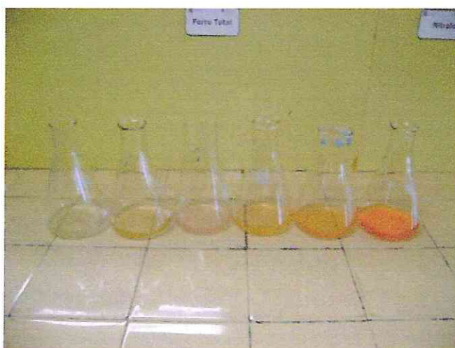
Figura 17 - Determinação de ferro. Quanto mais forte a coloração indica que maior é a concentração de ferro.
