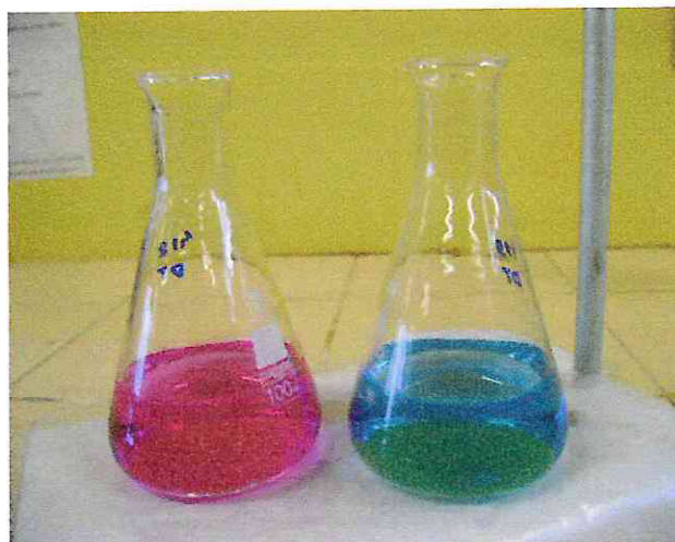
Figura 10 - Determinação da dureza total. A coloração rosa é antes da titulação com EDTA e a azul representa após a titulação determinando a dureza total.
