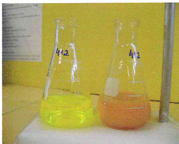
Figura 12 - Determinação de cloreto. Amostra com coloração amarela (esquerda) antes da titulação com nitrato de prata e a amostra de coloração alaranjada (direita) depois da titulação.
