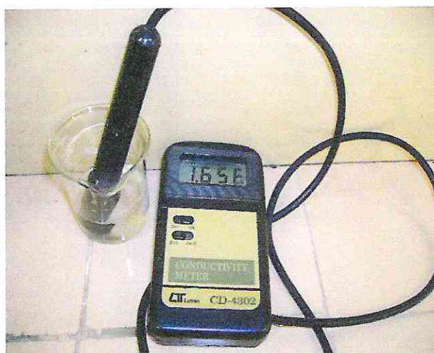
Figura 7 – Condutivímetro- “Conductivity Meter” –Lutron- CD4302
