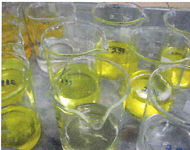
Figura 14- Determinação de nitrato. Quanto mais intensa a coloração, indica que maior é a concentração de nitrato.
