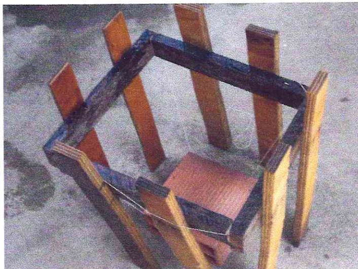
FIGURA 2. Estrutura utilizada para a fixação do perifiton
