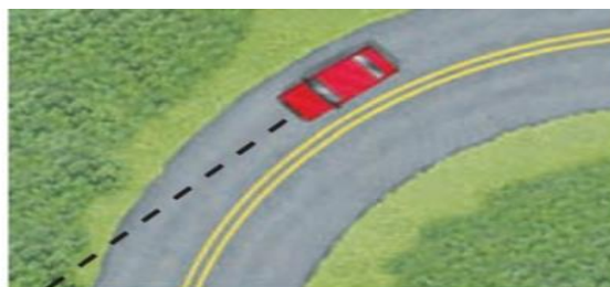
Figura 3 - Na ausência de atrito entre os pneus e o asfalto, o carro seguiria na linha pontilhada.
