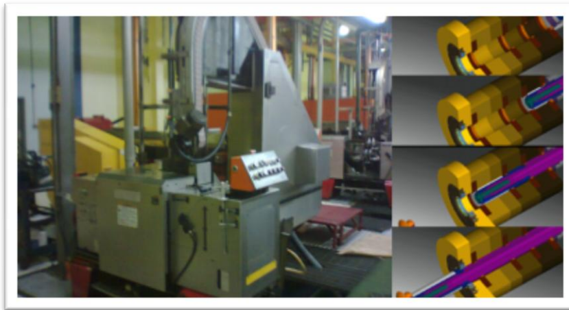
Figura 4: À esquerda, uma foto da Prensa Horizontal usada para realizar o estiramento dos copos vindos da Prensa Vertical (Fig. 3). À direita, de cima pra baixo, um esquema da máquina realizando o estiramento de um copo.
