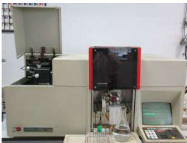
Figura 7 - Espectrofotômetro de absorção atômica utilizado (Perkin Elmer 1100B).
