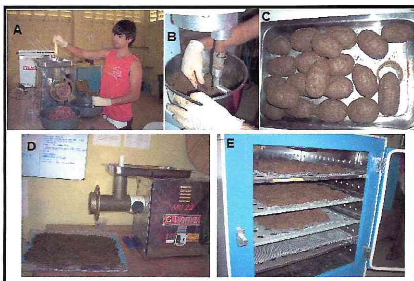
Figura 17: Sequência do processo da elaboração da ração. (A) - moagem dos ingredientes; (B) - mistura em bateadeira industrial; (C) - bolo de ração; (D) – peletização; (E) - secagem.
