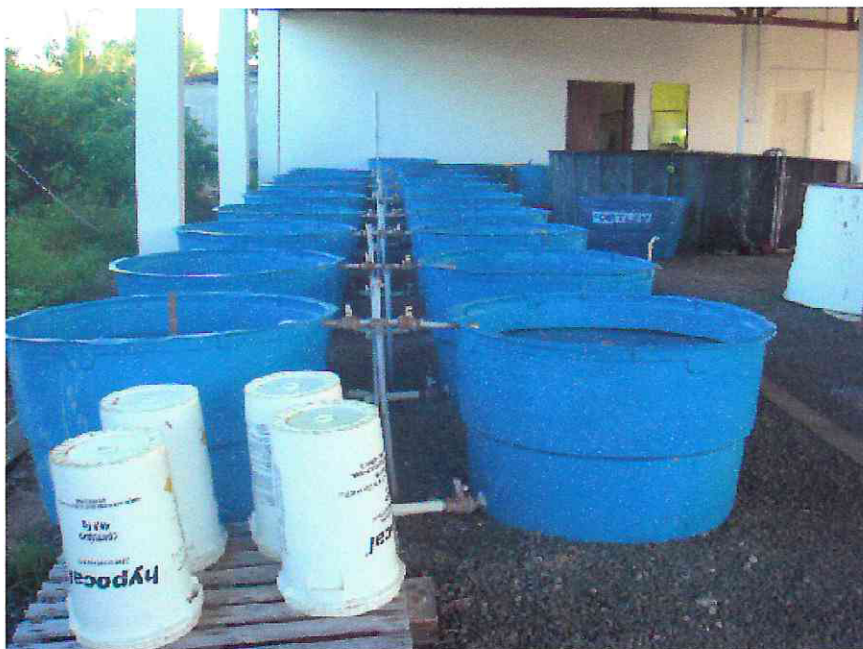
Figura 9: Área externa do laboratório. Em detalhe o sistema de recirculação composto por uma bateria de dezesseis tanques
