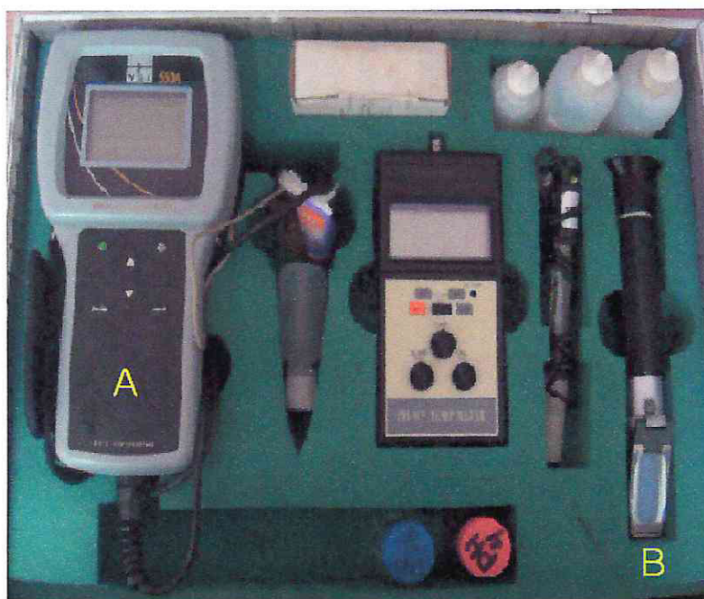
Figura 13: Aparelhos utilizados para medir os parâmetros físico-químico da água: (A) – Oxímetro ; (B) – Refratômetro óptico.
