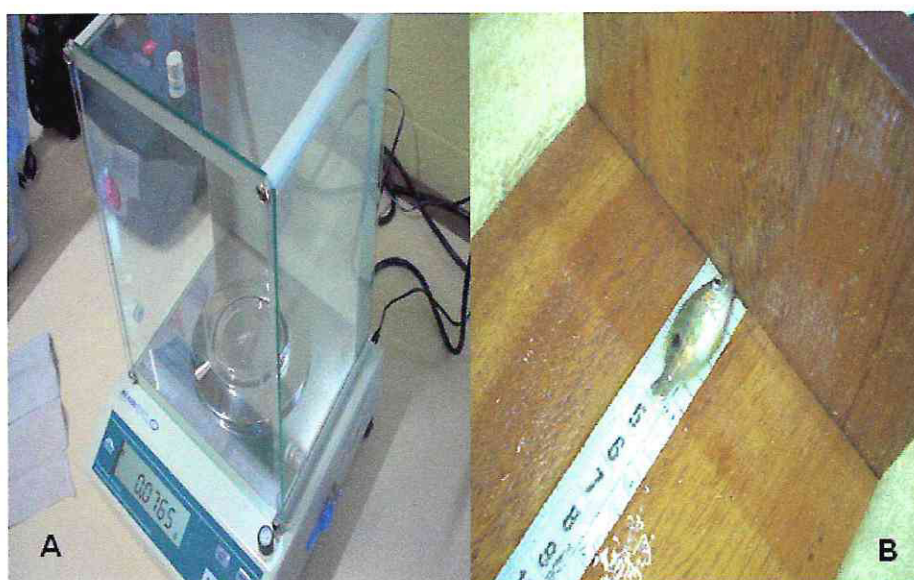
Figura 21: (A) – Balança digital, utilizada na pesagem dos indivíduos ; (B) – Ictiômetro, utilizado na medição do comprimento dos indivíduos.
