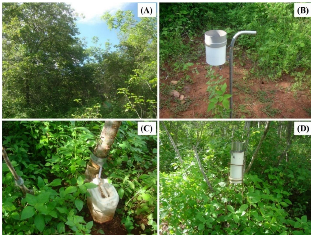
Figura 4 - Fisionomia da caatinga no período chuvoso (A), pluviógrafo de báscula (B), dispositivo de coleta de água que escoo pelos troncos das árvores (C) e pluviômetros para coleta da precipitação interna (D)
