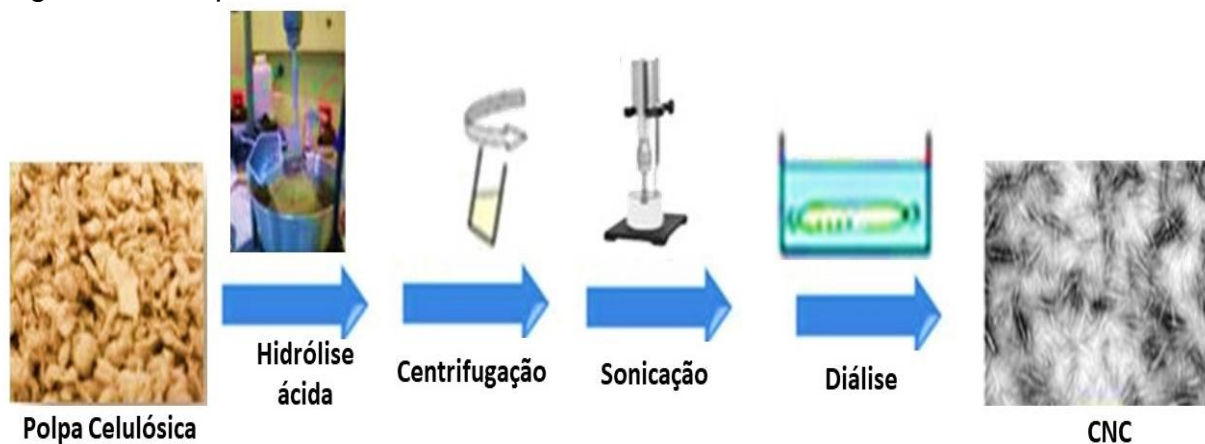
Figura 30 - Esquema ilustrativo do isolamento dos nanocristais de celulose.
