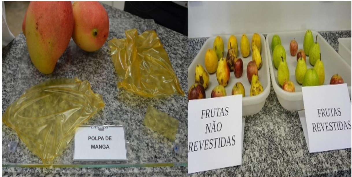
Figura 21 - Embalagens biodegradáveis (a) produzidas a partir de polpa de manga; (b) acompanhamento da degradação de frutas não revestidas e revestidas com filmes biodegradáveis.
