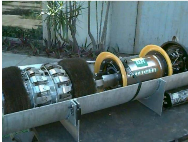
Figura 1-3: Robô PIG instrumentado para tubulações de 14" da PETROBRAS.
