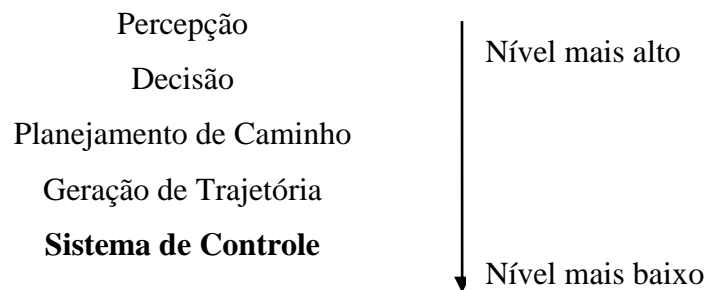
Figura 2-1: Níveis hierárquicos da arquitetura de navegação de robôs móveis.
