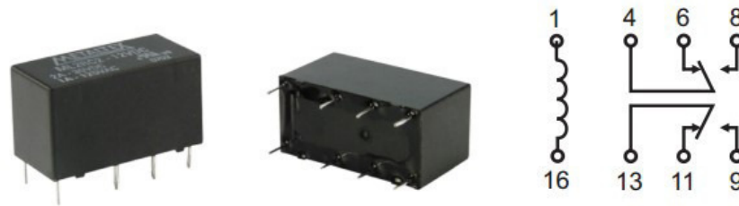
Figura 7 – Relé ML2RC2 e o seu diagrama elétrico visto de baixo
