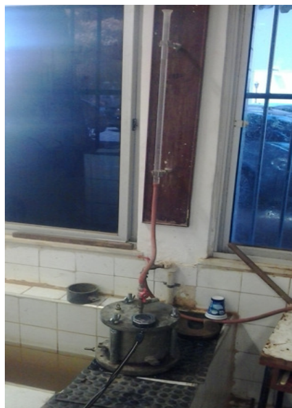
Figura 42 – Ensaio de permeâmetro de carga contínua
