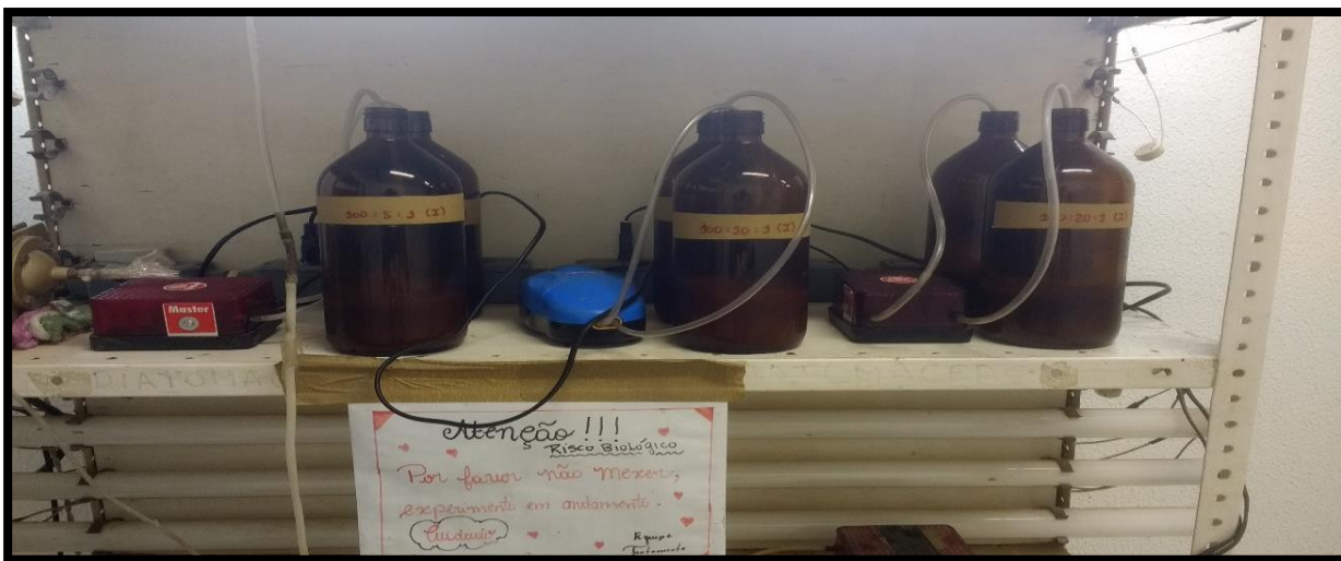
Figura 3: Imagem dos reatores montados para a remoção de matéria orgânica, analisando a influência dos nutrientes: nitrogênio e fósforo no EQUAL.
