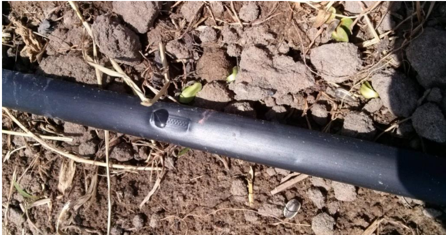
Figura 16 – Emissor autocompensante inserido na fita gotejadora, Fortaleza, Ceará, 2015
