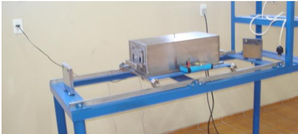
Figura 11: Fotografia do forno utilizado para a preparação de membranas por evaporação rápida.
