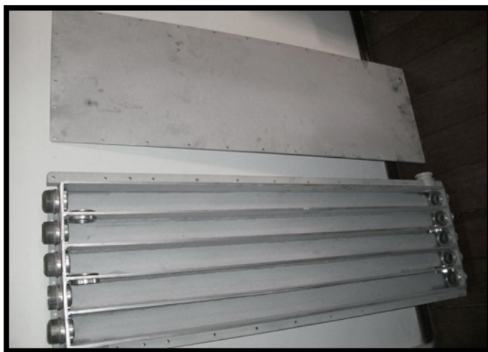
Figura 5.4 – Construção do Fotorreator híbrido concluída
