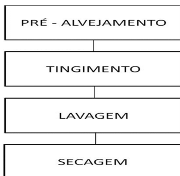
Figura 2.1 – Etapas do processo de tingimentos de fios de algodão para fabricação de redes de dormir
