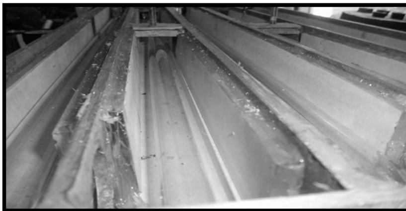
Figura 5.6 – Ambiente interno do fotorreator: lâminas de vidro com \text{TiO}_2 imobilizado e luvas de quartzo
