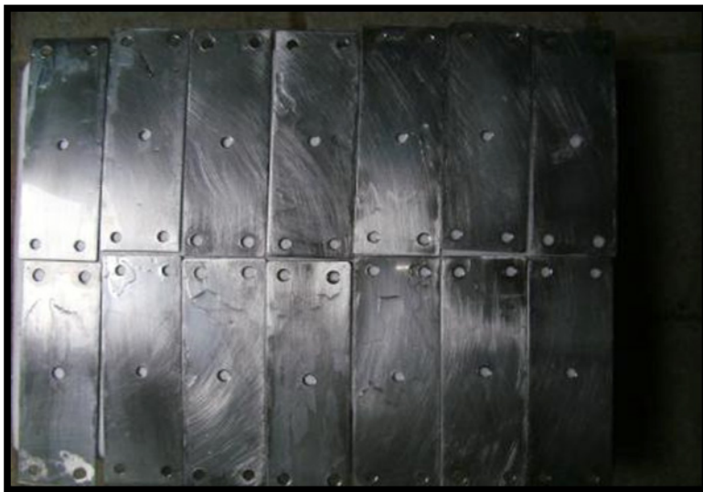
Figura 5.3 – Placas de aço inox, utilizadas como eletrodos
