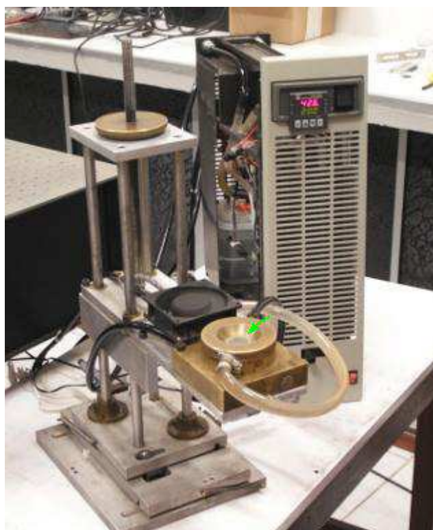
Figura 4.7: Forno utilizado nos experimentos Raman a altas temperaturas
