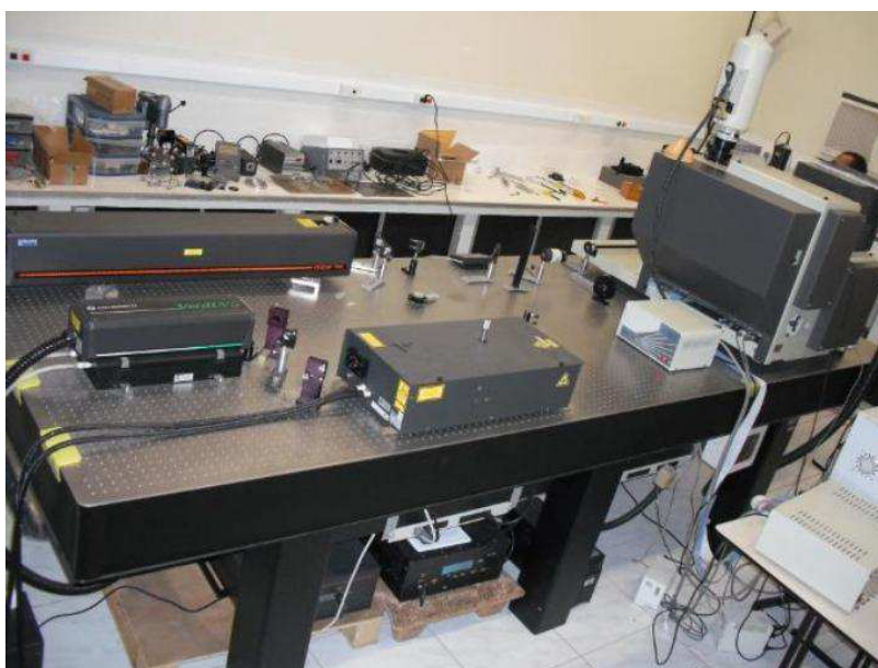
Figura 4.6: Espectrômetro Raman T64000 (à direita na figura).
