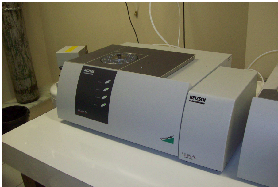
Figura 4.4: Equipamento de DSC utilizado, modelo DSC 204F1 da Netzsch.
