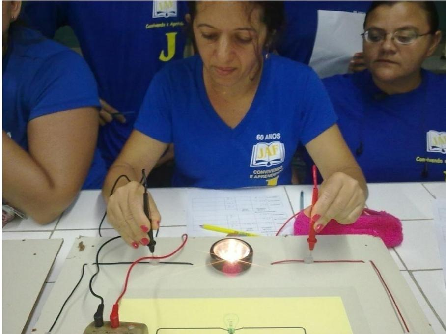
**A.3:** Alunos verificando a Tensão e a Corrente do Circuito Elétrico III
