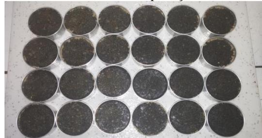
Cura dos corpos de prova imprimados
