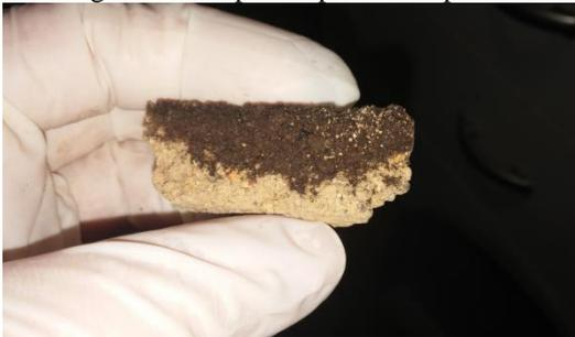
Corpo de prova rompido
