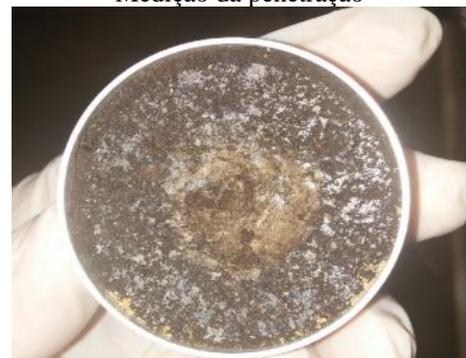
Corpo de prova após teste de coesão
