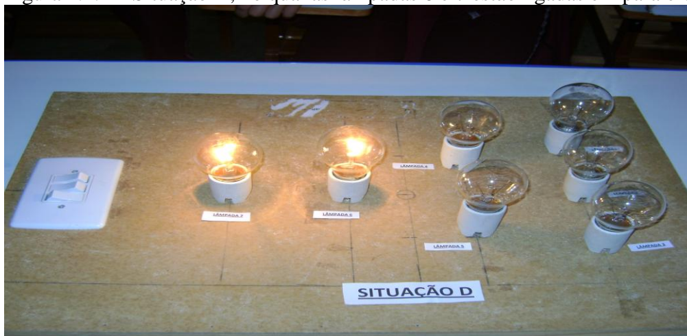
Figura 4.2.1 – Situação D, no qual as lâmpadas 6 e 7 estão ligadas em paralelo.
