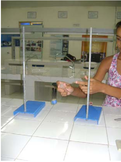
Resfriamento do fio de cobre para contração.
